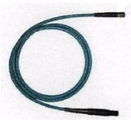
Speciale guida di luce a fibre ottiche appositamente realizzate per resistere ad alte temperature (fino a 300° C.). Esternamente è protetta da una guaina metallica ricoperta da PVC. A una delle estremità un bocchettone fissa la guida alla sorgente di luce, mentre l'altra estremità viene avvitata nell'apposito dispositivo dell'endoscopio. La lunghezza standard della guida è di 1800mm. Altre lunghezze e/o differenti diametri sono disponibili su richiesta.
