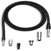
La guida di luce a fibre ottiche è realizzata con mono fibre in silicio purissimo di durata praticamente illimitata. Esternamente è protetta da una guaina metallica ricoperta da PVC. A una delle estremità un bocchettone fissa la guida alla sorgente di luce, mentre l'altra estremità viene avvitata nell'apposito dispositivo dell'endoscopio. La lunghezza standard della guida è di 1800mm. Altre lunghezze e/o differenti diametri sono disponibili su richiesta.
