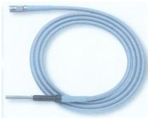
Speciale guida di luce al plasma appositamente realizzata per trasmissione UV (Resiste a temperature fino a 60° C.). Esternamente è protetta da una guaina metallica ricoperta da PVC. A una delle estremità un bocchettone fissa la guida alla sorgente di luce, mentre l'altra estremità viene avvitata nell'apposito dispositivo dell'endoscopio. La lunghezza standard della guida è di 1800mm. Il diametro è di 5mm.
